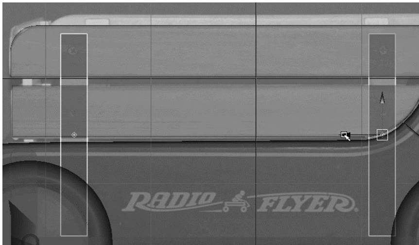
Rysunek 6.119. Kopię wspornika umieść bliżej końca wózka
