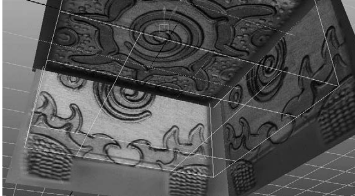
Rysunek 6.151. Podziel cztery razy dno pudełka, aby utworzyć ścianki dla nózek szkatuлки
